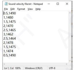
Рис. 5.2 Пример записей в файле скорости звука в воде
