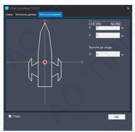
Рис. 4.7 Настройка параметров местоположения ГНСС-приёмника
