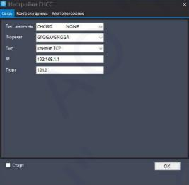
Рис. 4.6 Настройка связи с ГНСС-приёмником
