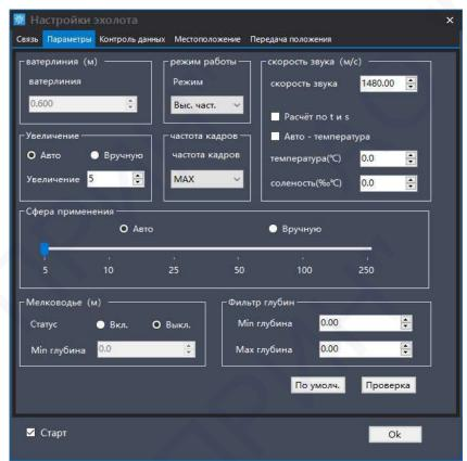
Рис. 4.4 Настройка параметров эхолота
