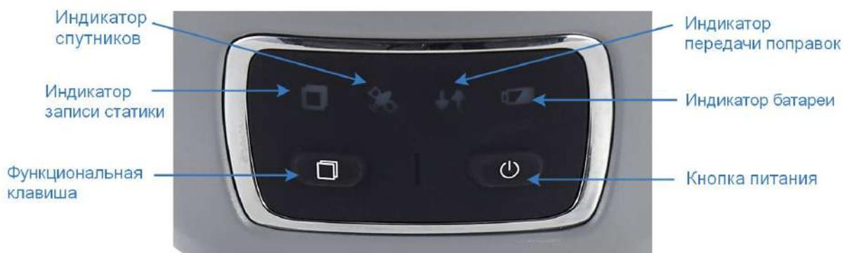
Рис. 1.2 Индикаторы и кнопки передней панели
