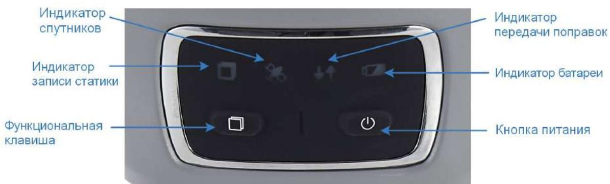
Рис. 1.2 Индикаторы и кнопки передней панели
