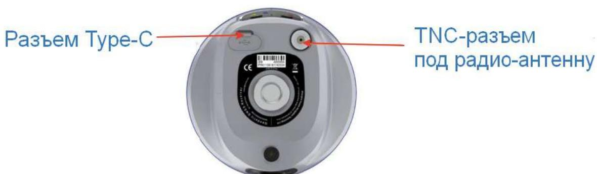
Рис.1.3 Корпус приёмника i30VR
