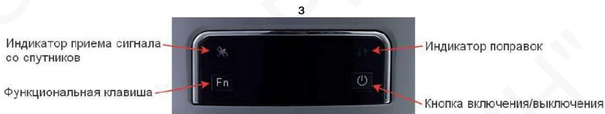
Рис. 1.2 Индикаторы и кнопки передней панели
