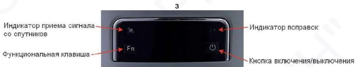
Рис. 1.2 Индикаторы и кнопки передней панели
