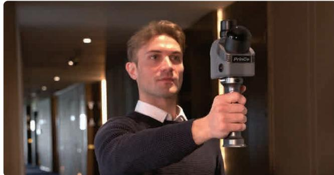
Благодаря сверхширокому полю зрения  $360^\circ \times 189^\circ$  возможно измерение всего окружающего пространства без необходимости подбора оптимального угла сканирования.
