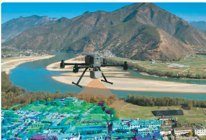
Высота полёта - 120 м, частота излучения - 2 млн имп./с, плотность - 460 т/м 2
