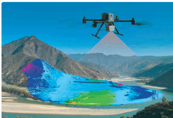
Высота полёта - 400 м, частота излучения - 300 тыс. имп./с, плотность - 20 т/м 2
