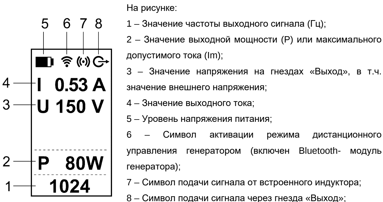
Рисунок 1.3 - Индикатор генератора
