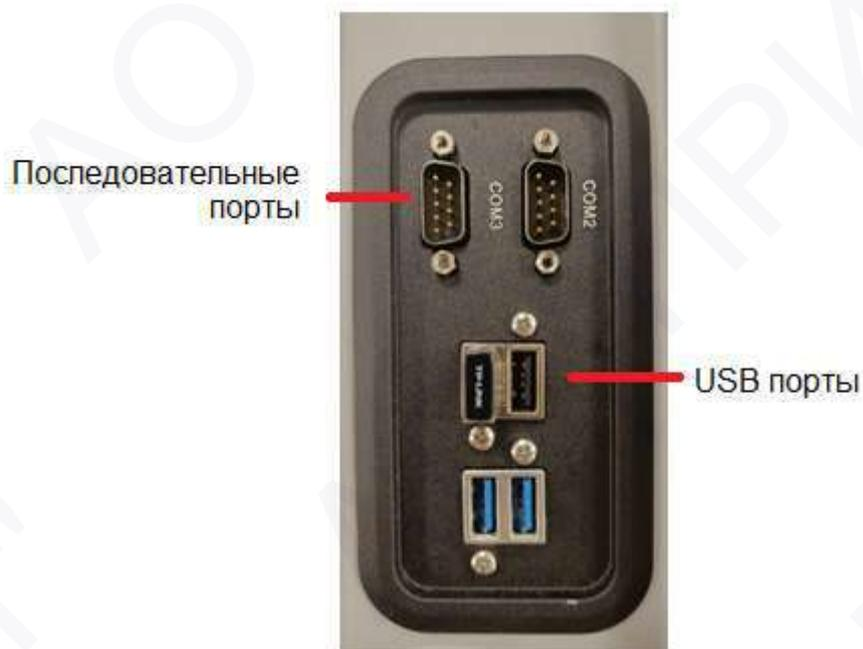
Рис. 2.2 Разъёмы на левой стороне
