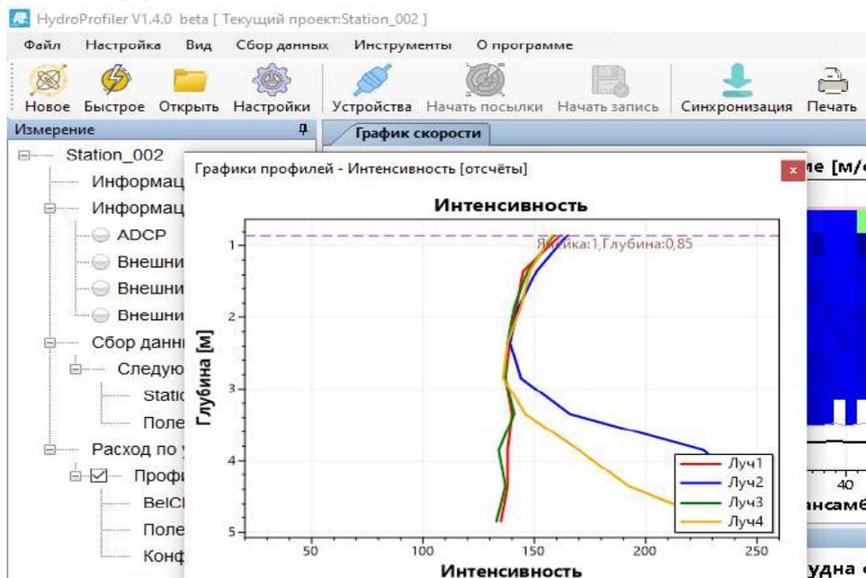
Рис.6.8 Профиль интенсивности
