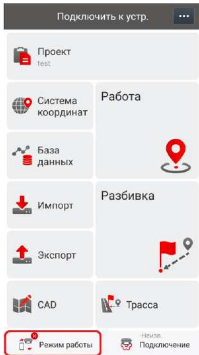
Для подключения приемника к контроллеру нужно перейти во вкладку «Режим работы»
