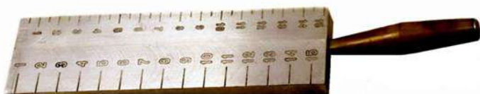
Рисунок 5 – Общий вид клинового промерника
