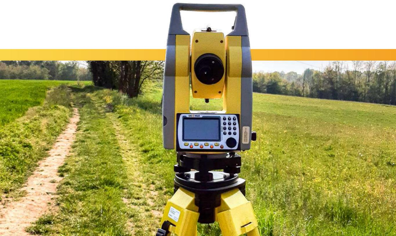
**Прочный корпус тахеометра Zoom25 защищает прибор от пыли, водяных струй с любого направления и низких температур до -30°C.**
