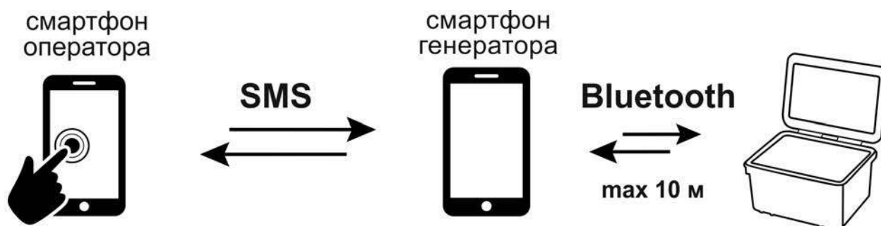
Рисунок 2.8 – Организация дистанционного управления генератором
