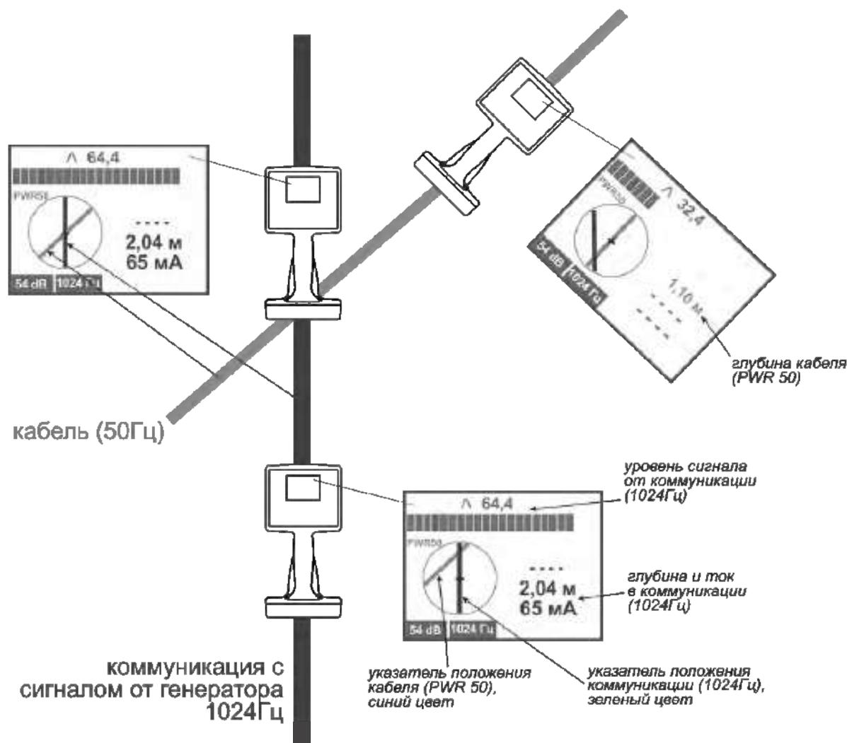
Рисунок 4.2.36 – Поиск с включенной функцией «Вторая линия»
