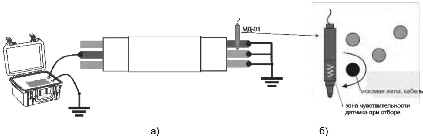
Рисунок 5.4.1 – Схема подключения при отборе жил кабеля
