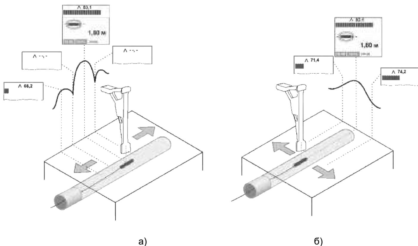
Рисунок 4.5.2 – Определение точного положения и глубины залегания зонда
