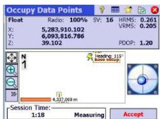
Если установлен флажок **Круг. эл. уровень** на вкладке **Реж. измер.** для точки определенного типа (**Данные**, **Топо**, **Контроль** и т. п.), Survey Pro проверит, чтобы приемник был выставлен по уровню до записи точки этого типа. Если это не так, вам не будет разрешена запись точки.
