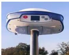
Spectra Geospatial SP85 представляет собой приемник GNSS нового поколения, сочетающий опыт технологии RTK GNSS, накопленный в течение десятилетий, с революционно новым процессом обработки данных GNSS.
