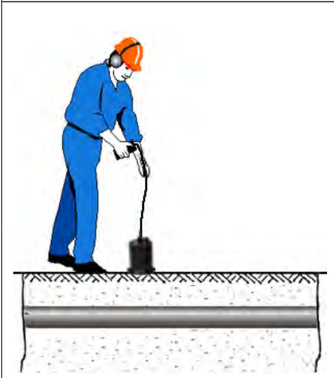
4. Установить акустический датчик над предполагаемой трассой
