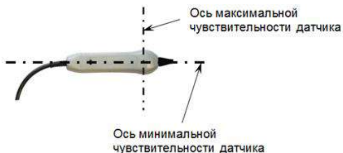
Рисунок А.2 Оси чувствительности датчика ЭМД-127.
