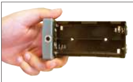
б) Вставить батареи в отсек, соблюдая полярность
