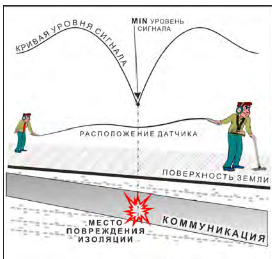
применение датчика-определителя дефектов коммуникации (ДОДК) методом min
