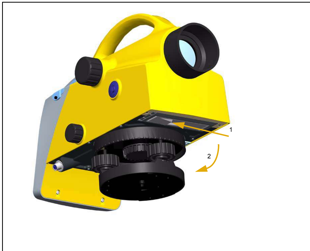
Рис. 3.1 Открытие батарейного отсека
