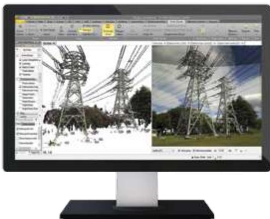
Вместе с полевым программным обеспечением Trimble Access, сканирующий тахеометр SX10 позволяет с высокой производительностью и надежностью собирать в поле максимально полные наборы данных. Trimble Access упрощает работу, позволяя объединять данные оптических наблюдений, сканы, GNSS-данные и изображения в едином проекте.
